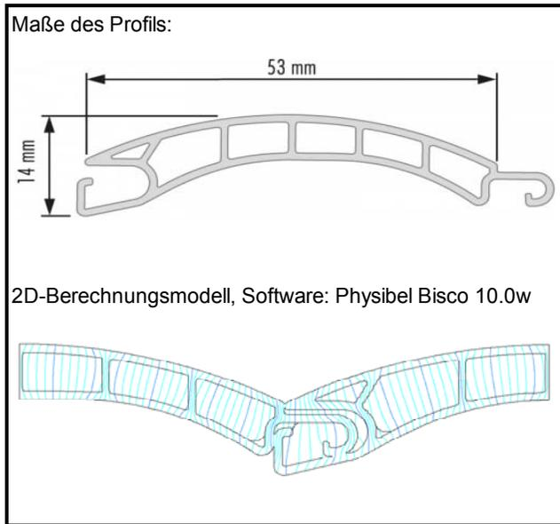
Wärmedurchlasswiderstand  $R_{sh}$  nach DIN EN ISO 10077-2:2012-06:
